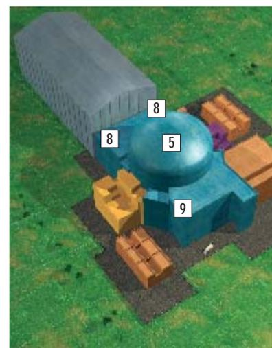
La coque externe <sup>(7)</sup> recouvre le bâtiment réacteur <sup>(5)</sup>, celui abritant le combustible usé <sup>(9)</sup> et deux des 4 bâtiments de sauvegarde <sup>(8)</sup>. Les 2 autres bâtiments de sauvegarde bénéficient d'une protection par séparation géographique.
