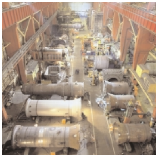
Dimensionnée pour produire simultanément les composants de six tranches par an, l'usine Framatome à Chalon-Saint-Marcel a fabriqué tous les gros composants chaudronnés du programme nucléaire français.
