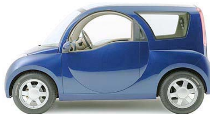
Bluecar - Bolloré - LMP( \div 3 vol \div 5 kg - 200km) 10 ans - rech 6 h - 20kE - 125 km/h - 2008
